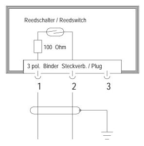
1 Impuls  $\stackrel{\frown}{=}$  0,2 mm Niederschlag 1 Pulse  $\stackrel{\frown}{=}$  0,2 mm Precipitation Schaltleistung : / Switching load
